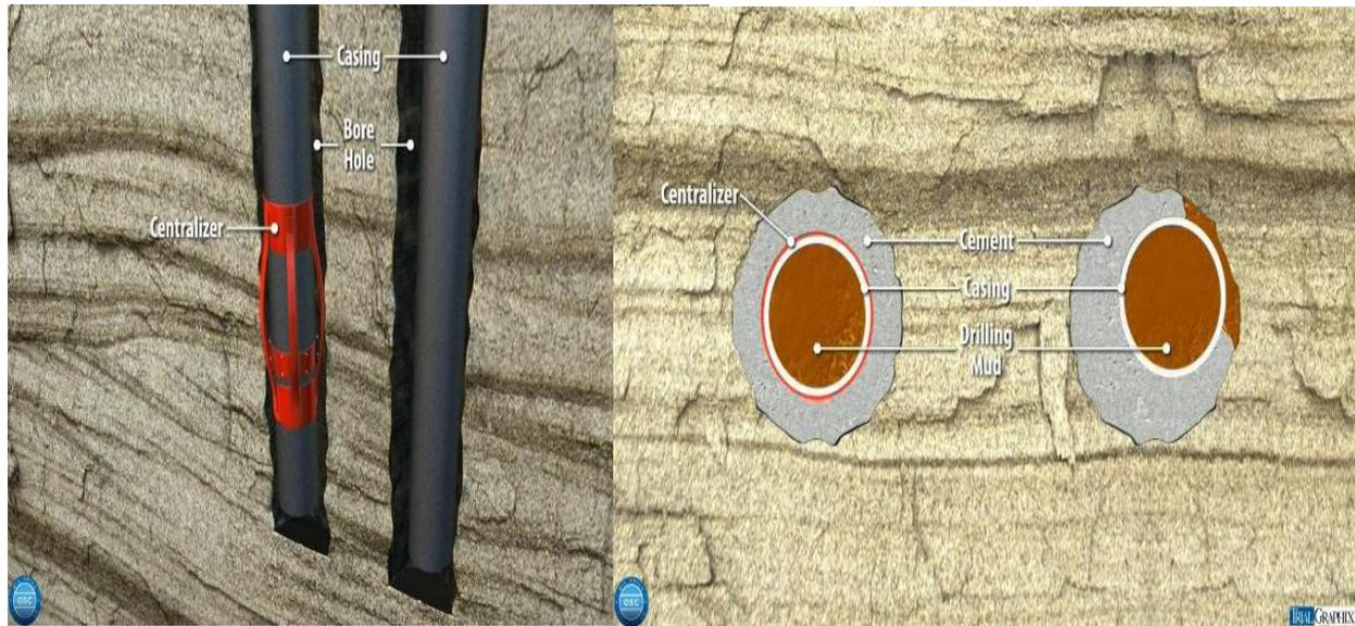
Figure 1.16 – Centralizers.<sup>50</sup>
