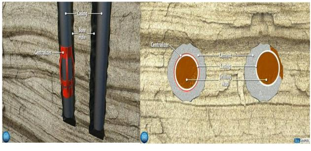
Figure 1.16 – Centralizers.<sup>50</sup>
